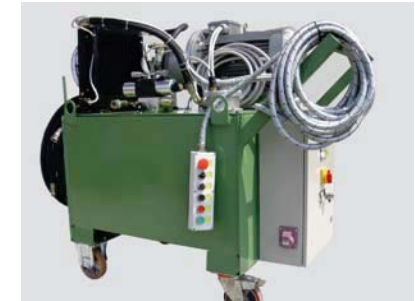
DISPONIBILE CENTRALINA IDRAULICA CAPACITÀ OLIO 200 L, CON TELECOMANDO ED INTERCOOLER PER RAFFREDDAMENTO.
