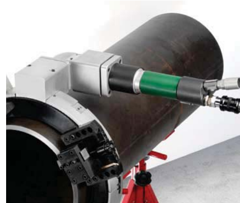
MOTORIZZAZIONI DISPONIBILI ANCHE CON POSIZIONAMENTO A 90° PER PIAZZAMENTO IN SPAZI RIDOTTI.
